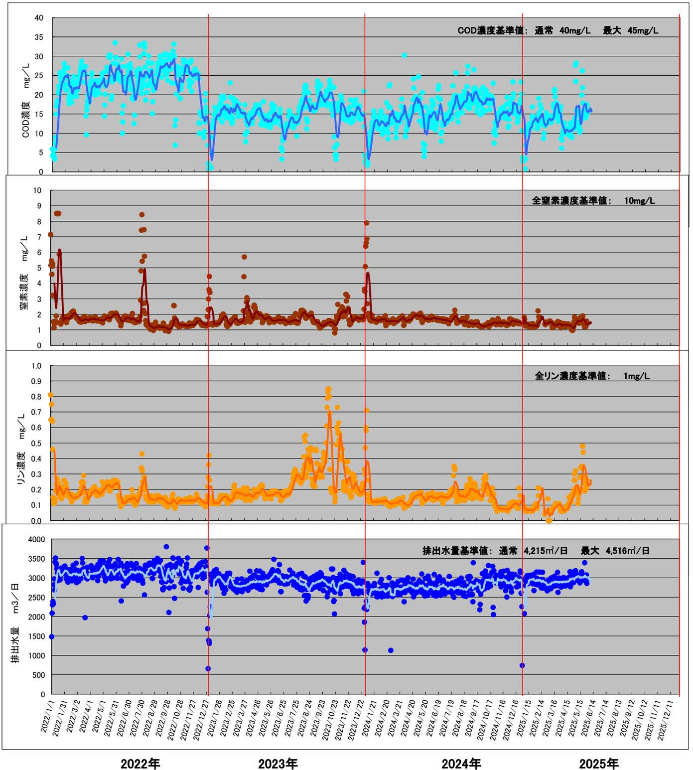
※上図に示したデータは、管理用の自動分析装置で測定した排水の水質分析結果と自記流量計により測定した排水量である。
